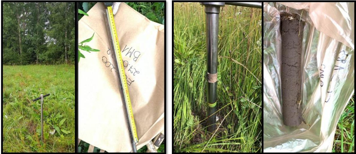
Joonis 10. Mulla huumushorisoni tuseduse hindamiseks kasutatud mullapuur (vasakul) ning maa-aluse biomassi proovide võtmiseks kasutatav mullapuur ja mullamonoliit.
